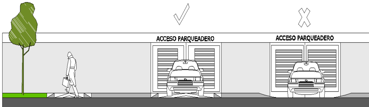
Gráfica N° 6. Modelo para implementación de rampas peatonal y vehicular en alzado.
